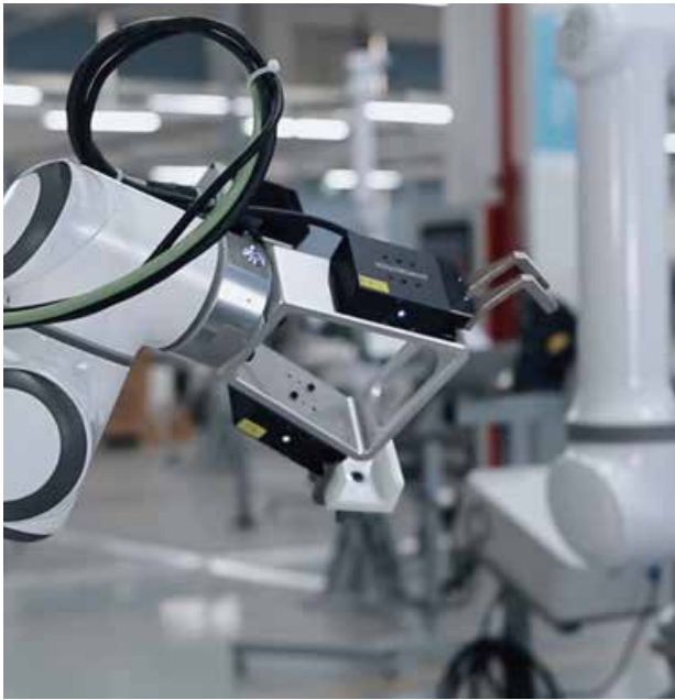
PGE-8-14 自动化应用 一台协作机器人搭载两台大寰电爪，完成上下料任务
