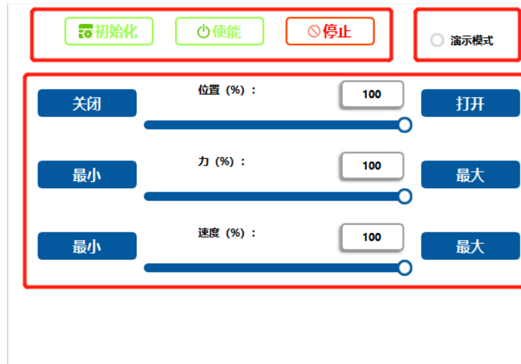
图 4.2.3 伺服电动夹爪-控制模块
